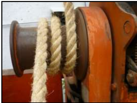
FIGURA 4.- CUERDA ENROLLADA EN EL SENTIDO DE LAS MANECILLAS DEL RELOJ, CON 1.75 VUELTAS
